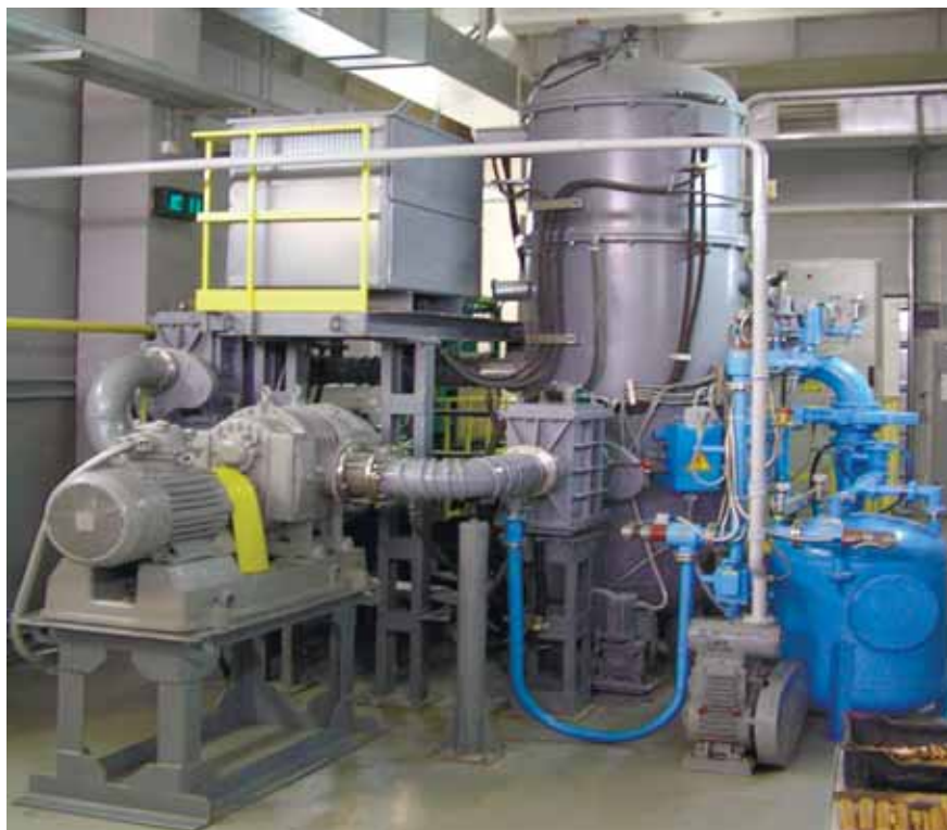
Рис. 2. Вакуумная элеваторная электропечь сопротивления модели СЭВГ-3.3/13-ИЗГ-НИТТИН
