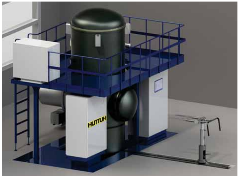
Рис. 1. Вакуумная элеваторная электропечь модели СЭВЭ-5.5/13-ИЗГ-НИТТИН. Буквенно-цифровое обозначение: С – нагрев сопротивлением; Э – конструктивный признак – элеваторная; В – среда в рабочем пространстве (вакуум); Э – тип теплоизоляции – экранно-вакуумная; 5 – диаметр рабочего пространства, дм; 5 – высота рабочего пространства, дм; 13 – номинальная температура, сотни °С; И – исполнение; ИЗГ – охлаждение садки в газе; НИТТИН – торговая марка.
